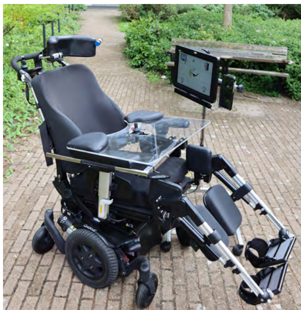
Afbeelding 1. De elektrische rolstoel van Mehmed met de omgevingsbediening op verrijdbaar statief.
